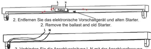
2. Entfernen Sie das elektronische Vorschaltgerät und alten Starter.
