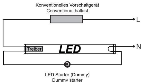
Herkömmliche Kompakteuchtstofflampen dürfen **nicht** mit diesem Starter verwendet werden! Kennzeichnen Sie die Leuchte entsprechend.
